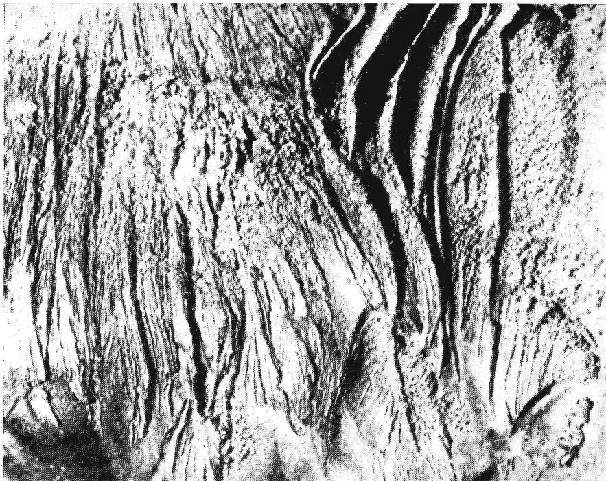
СТРУКТУРА КОРЫ ПЛАВЛЕНИЯ одного из целых индивидуальных экземпляров, найденных в районе падения Сихотэ-Алинского метеоритного дождя. Отчетливо видны следы абляции: струйки, растекающиеся по поверхности метеорита (увеличено в 15 раз)
