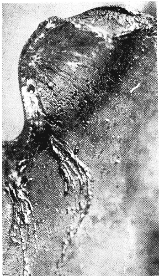
СЛЕДЫ АБЛЯЦИИ — растекающиеся струйки, натечность и разбрызганные капельки-шарики — на поверхности образца вблизи его края (увеличено в 30 раз)
